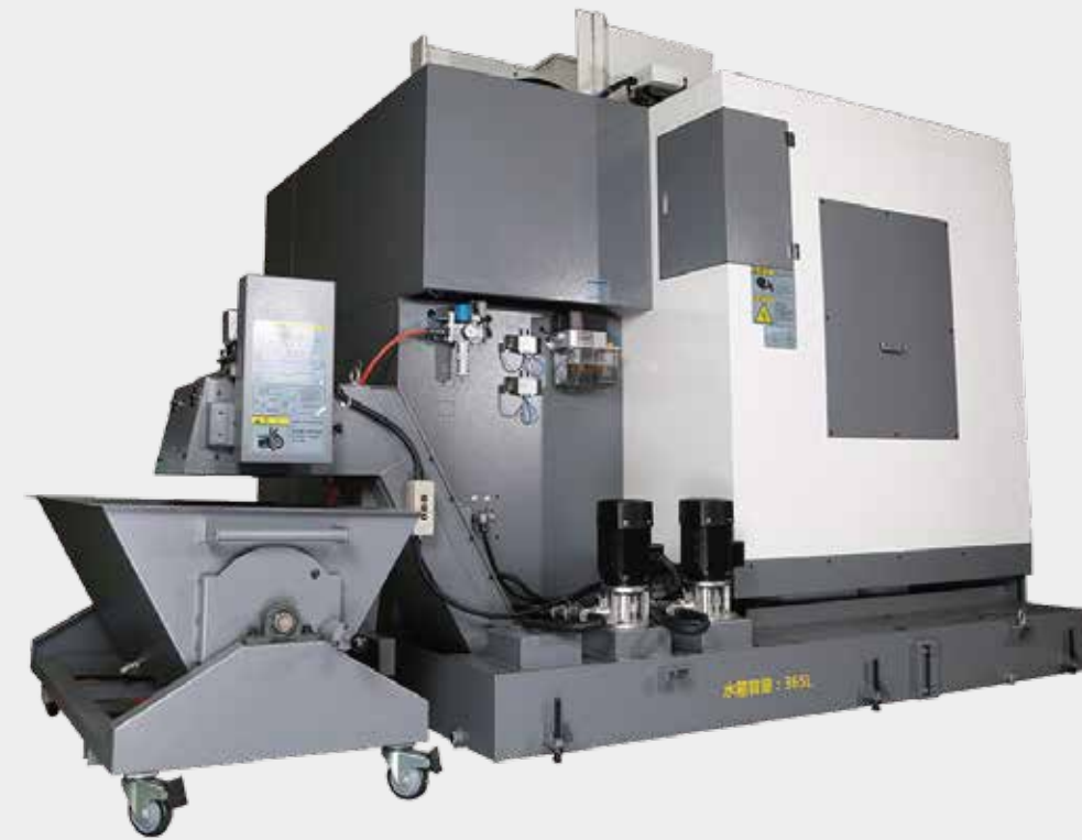
螺旋+链板后出式排屑器的设计可以有效提升生产场地的利用效率
